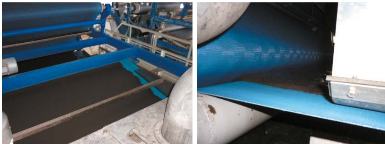
Рис. 7. Распределение сгущенного ила по нижнему полотну фильтр-пресса (слева) и клиновидная зона фильтр-пресса (справа)
