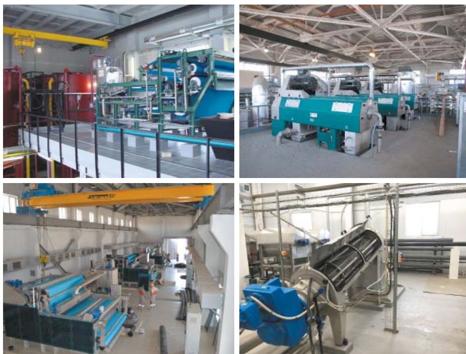
Рис. 2. Примеры реализации КТР «МУ-Sake» компанией «МАЙ ПРОЕКТ». СЛЕВА ВВЕРХУ И ВНИЗУ — ЛЕНТОЧНЫЕ ФИЛЬТР-ПРЕССЫ, СПРАВА ВВЕРХУ — ЦЕНТРИФУГИ, СПРАВА ВНИЗУ — ШНЕКОВЫЙ ПРЕСС
