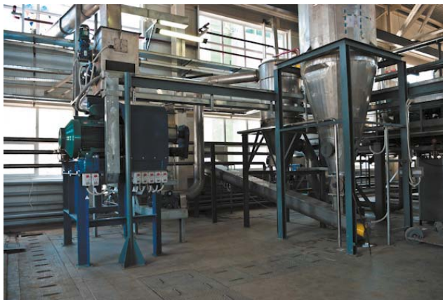
Рис. 3. ПРИМЕР РЕАЛИЗАЦИИ КТР «MY-Termo» компании «МАЙ ПРОЕКТ» НА БАЗЕ ВЫСОКОТЕМПЕРАТУРНОЙ ТУРБОСУШКИ
