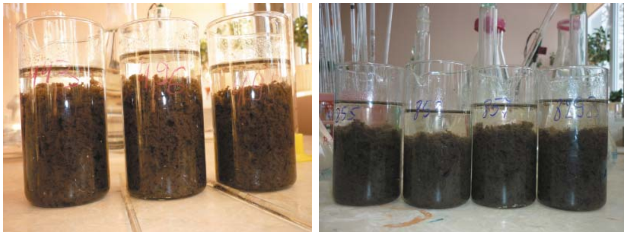
Рис. 5. Результаты смешения исходного ила с различными флокулянтами в лабораторных условиях
