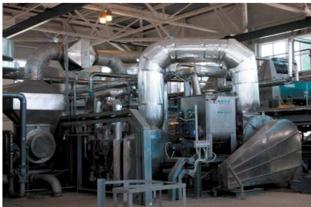
Рис. 3. ПРИМЕР РЕАЛИЗАЦИИ КТР «MY-Termo» компании «МАЙ ПРОЕКТ» НА БАЗЕ ВЫСОКОТЕМПЕРАТУРНОЙ ТУРБОСУШКИ
