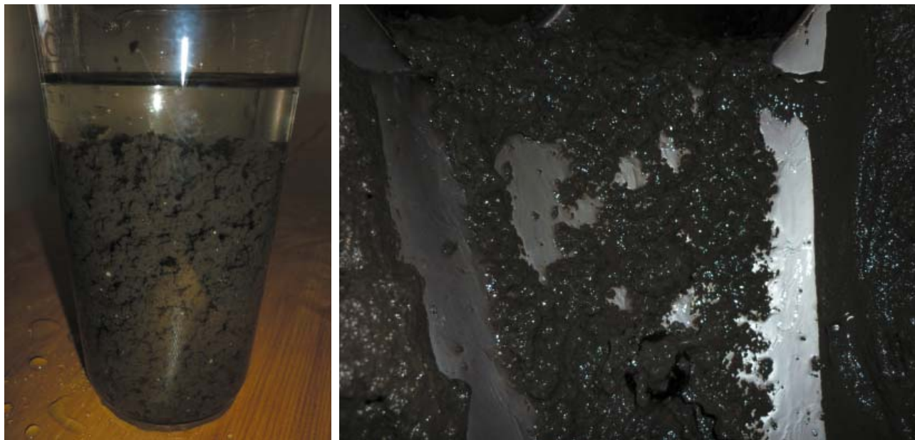
Рис. 6. Сfloкулированный ил перед подачей на шнековый сгуститель (слева). Сгущенный ил перед подачей на ленточный фильтр-пресс (справа)
