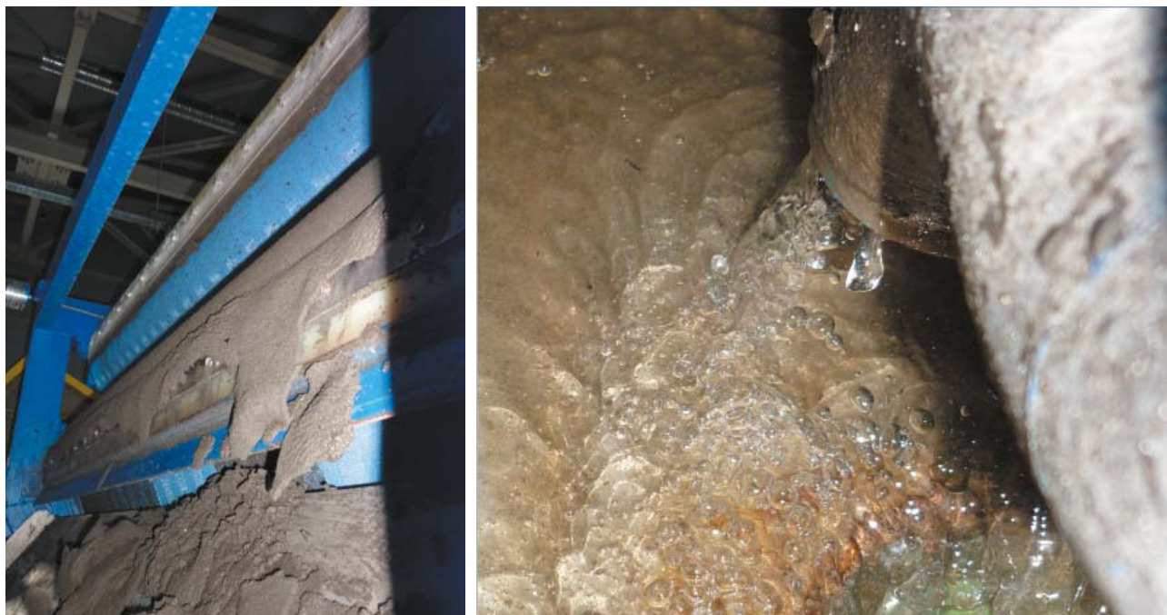
Рис. 9. Обезвоженный ил на узле съема с фильтр-пресса и фильтрат в поддоне
