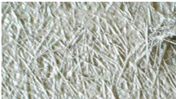
Рис. 6. Вид поверхности стеклофибробетона (GRC)
