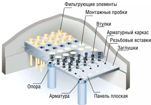
Рис. 3. СИСТЕМА монолитного фильтрующего дна с плоскими панелями
