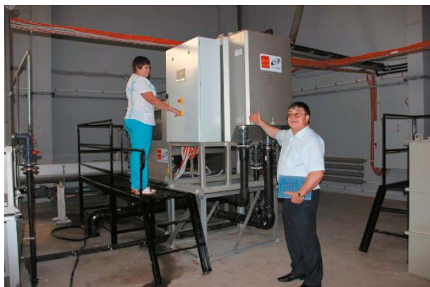
Рис. 2. Мультидисковый шнековый дегидратор MDQ-352 С (Горно-Алтайск, Россия)
