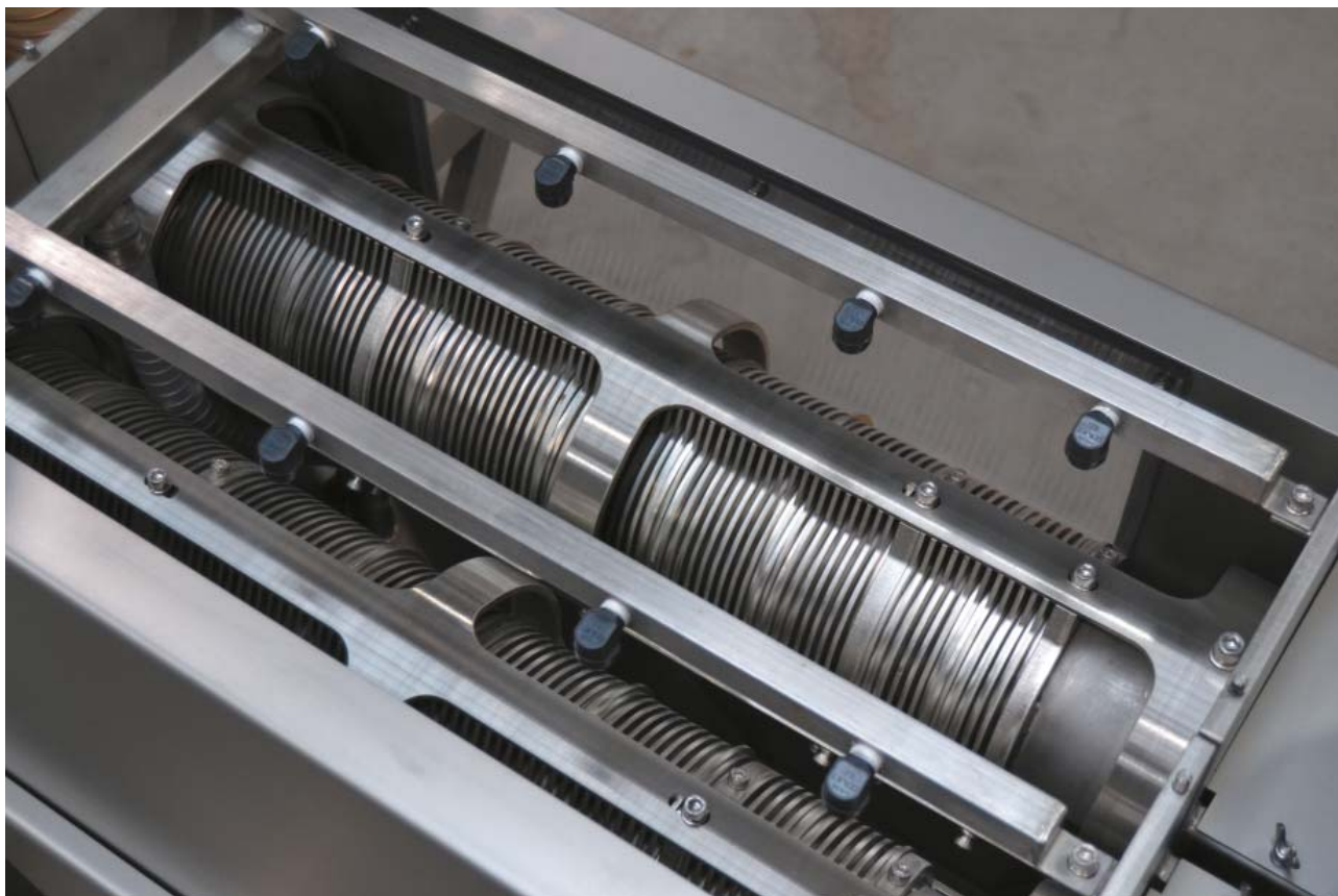
Рис. 6. Обезвоживающие барабаны мультидискового шнекового дегидратора
