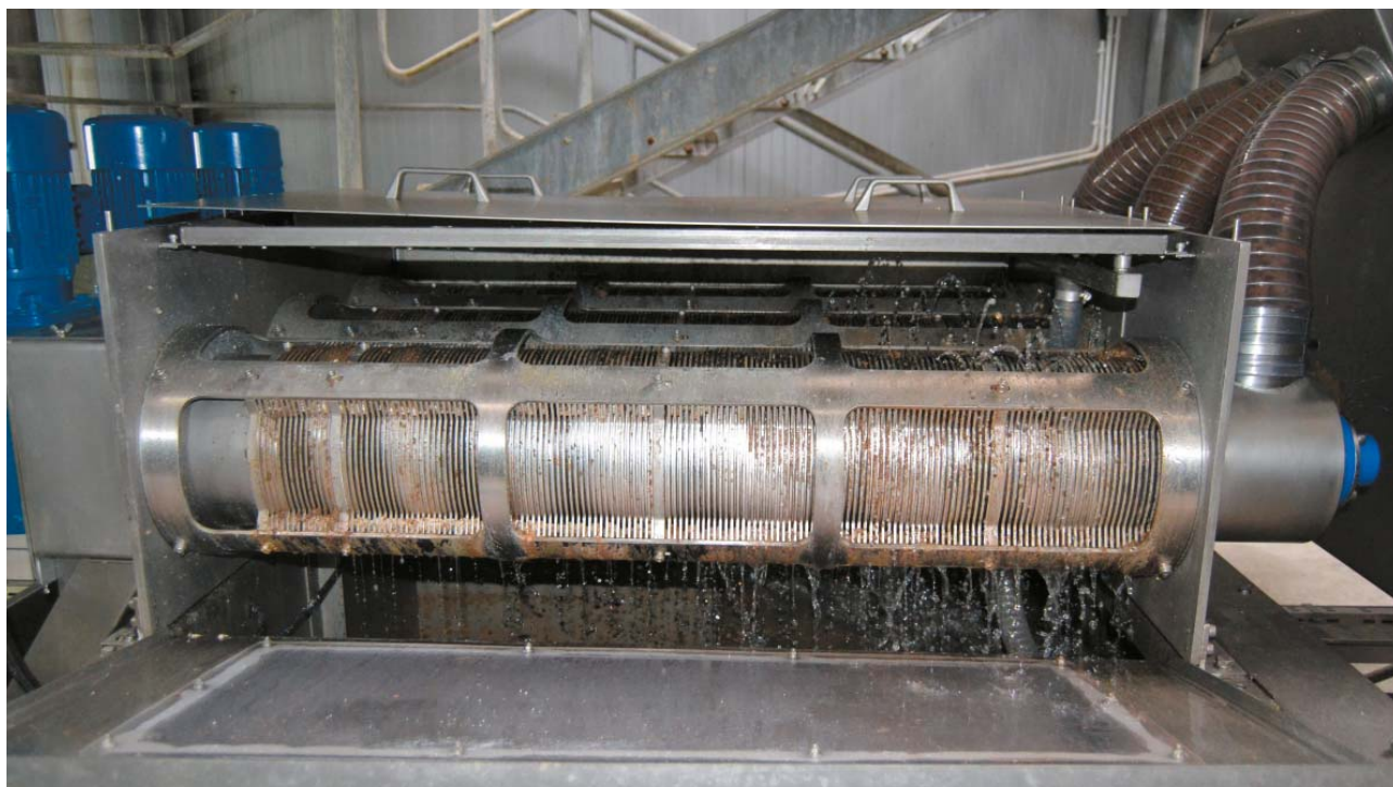
Рис. 5. Промывка обезвоживающего барабана мультидискового шнекового дегидратора
