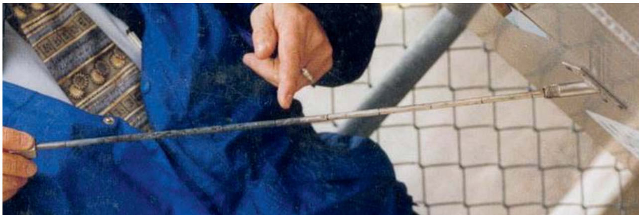
Рис. 1. Щуп для определения износа адсорбента
