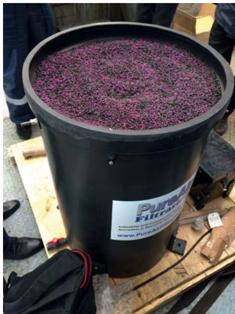
Рис. 3. ЗАГРУЗКА АДСОРБЕНТА В ФИЛЬТР ДСК-100
