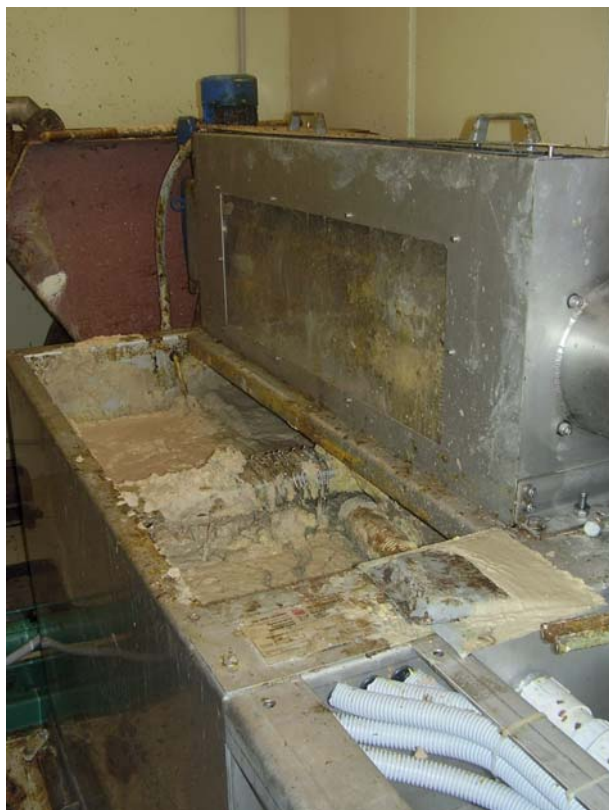
Рис. 1. ФЛОТАЦИОННАЯ УСТАНОВКА ПТИЦЕФАБРИКИ С ПРОБЛЕМАМИ В РАБОТЕ СИСТЕМ САТУРАЦИИ ВОЗДУХА И РАСПРЕДЕЛЕНИЯ ВОДОВОЗДУШНОЙ СМЕСИ
