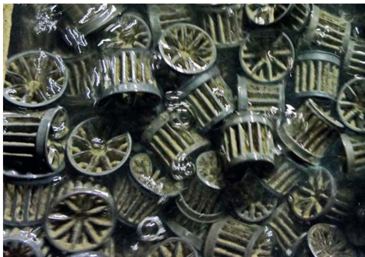
Рис. 6. Биоагрузка биофильтра после проведения работ. Видно хорошее обрастание биопленкой
