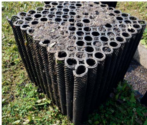
Рис. 3. Блочная загрузка после извлечения: каналы забиты мусором
