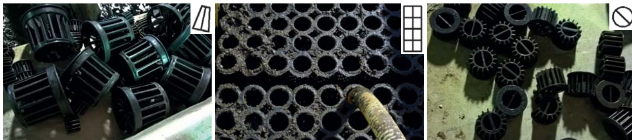
Рис. 2. Носители биопленки, изначально использованные в установке: а – загрузка биореактора 1-й ступени; б – 2-й и 3-й ступеней, в – 4-й ступени. Графические символы в правом верхнем углу на каждом фото соответствуют символам, обозначающим этот вид загрузки на рис. 1а
