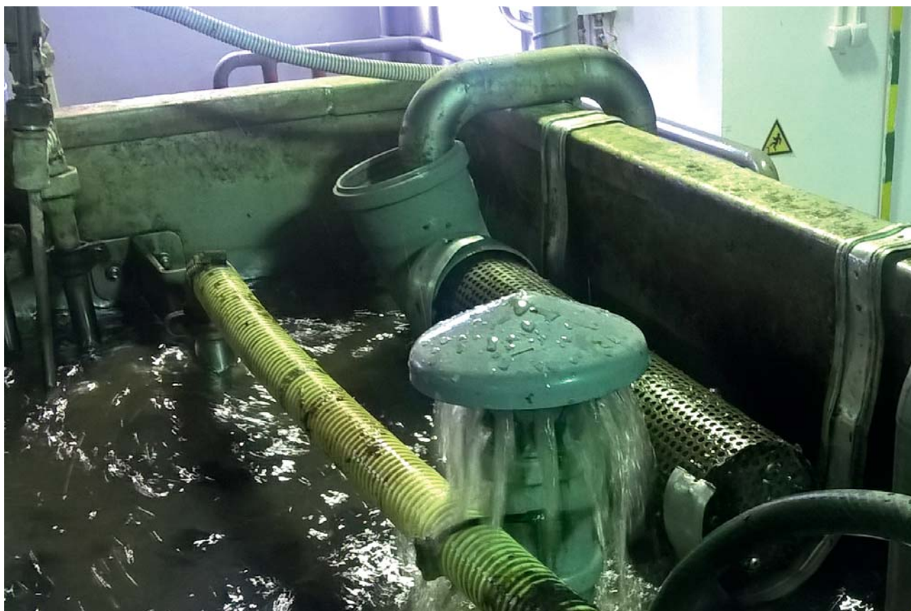
Рис. 4. Биофильтр с оросительной системой и подающий трубопровод с сеткой
