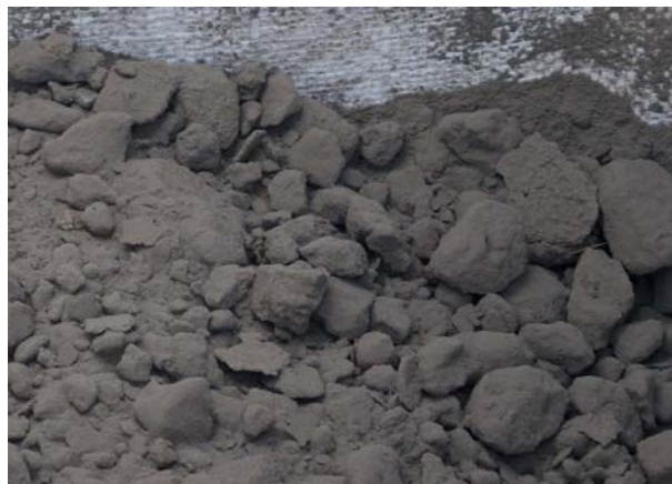
Рис. 7. Собираемая зола из фильтра очистки выбросов
