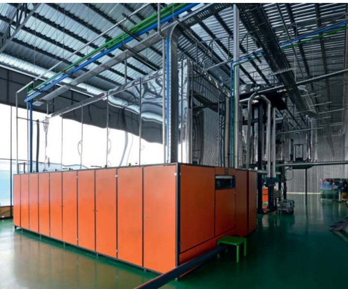
Рис. 9. Установка в Демирташ производительностью 30 т/сут (минимальная модель типоряда). На переднем плане — печь в кожухе, к ней проведена труба насосной подачи осадка
