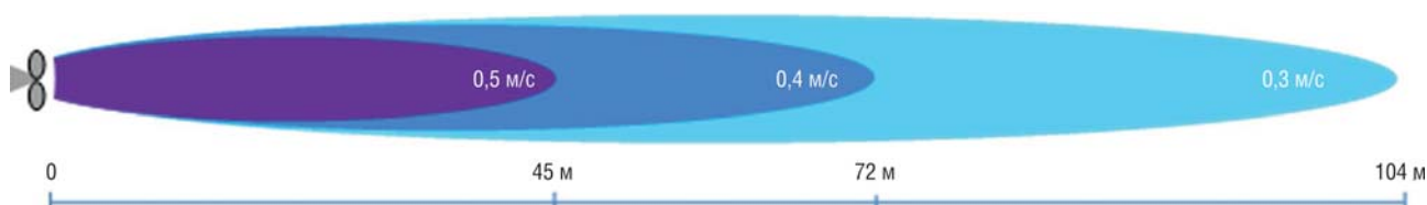
Рис. 6. Эпюра скоростей течения водяной струи, формируемой потокообразователем с низкооборотным пропеллером большого диаметра (D = 2750 мм)
