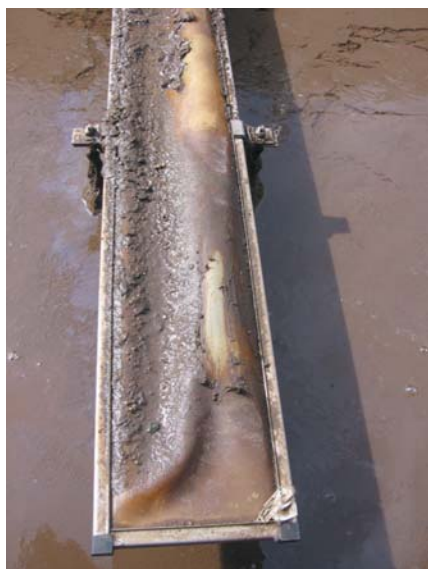
Рис. 3. НЕОБРАТИМАЯ ДЕФОРМАЦИЯ МЕМБРАН АЭРАТОРЫ AQUASTRIP ПОСЛЕ НЕСКОЛЬКИХ ЛЕТ ЭКСПЛУАТАЦИИ
