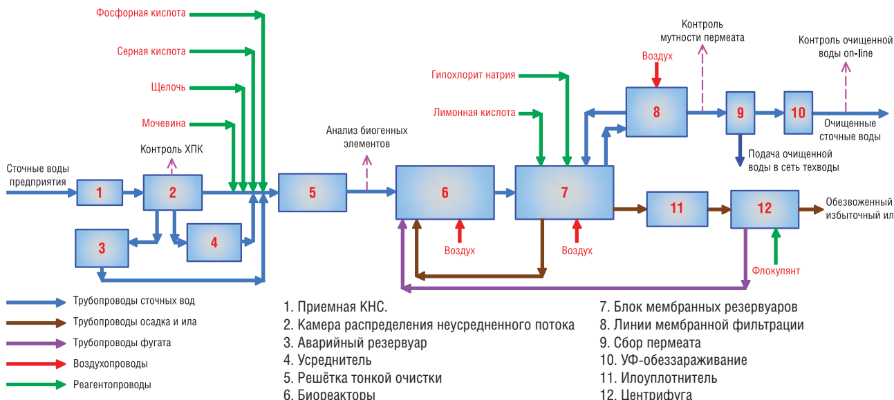
Рис. 6. УПРОЩЕННАЯ ПРИНЦИПИАЛЬНАЯ ТЕХНОЛОГИЧЕСКАЯ СХЕМА ЛОС ООО «ПЕПСИКО ХОЛДИНГС»
