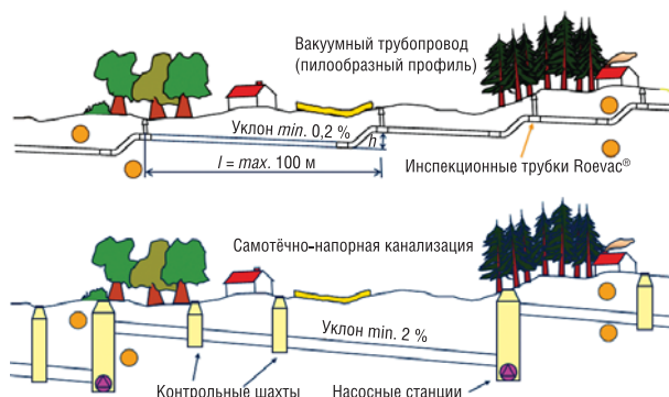
Рис. 6. Вакуумный трубопровод и самотечно-напорная канализация
