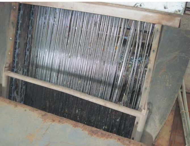
Рис. 2. Покрышка, деформировавшая полотно барабанной решетки
