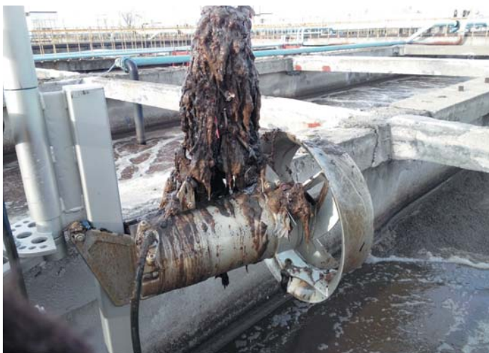
Рис. 3. Результат отсутствия решеток в технологической схеме: проблемы при эксплуатации азротенков
