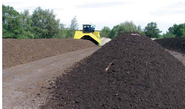
Рис. 11. БУРТОВОЕ КОМПСТИРОВАНИЕ ОСАДКА В КОХТЛА-ЯРВЕ
