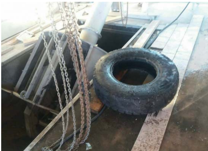
Рис. 2. Покрышка, деформировавшая полотно барабанной решетки
